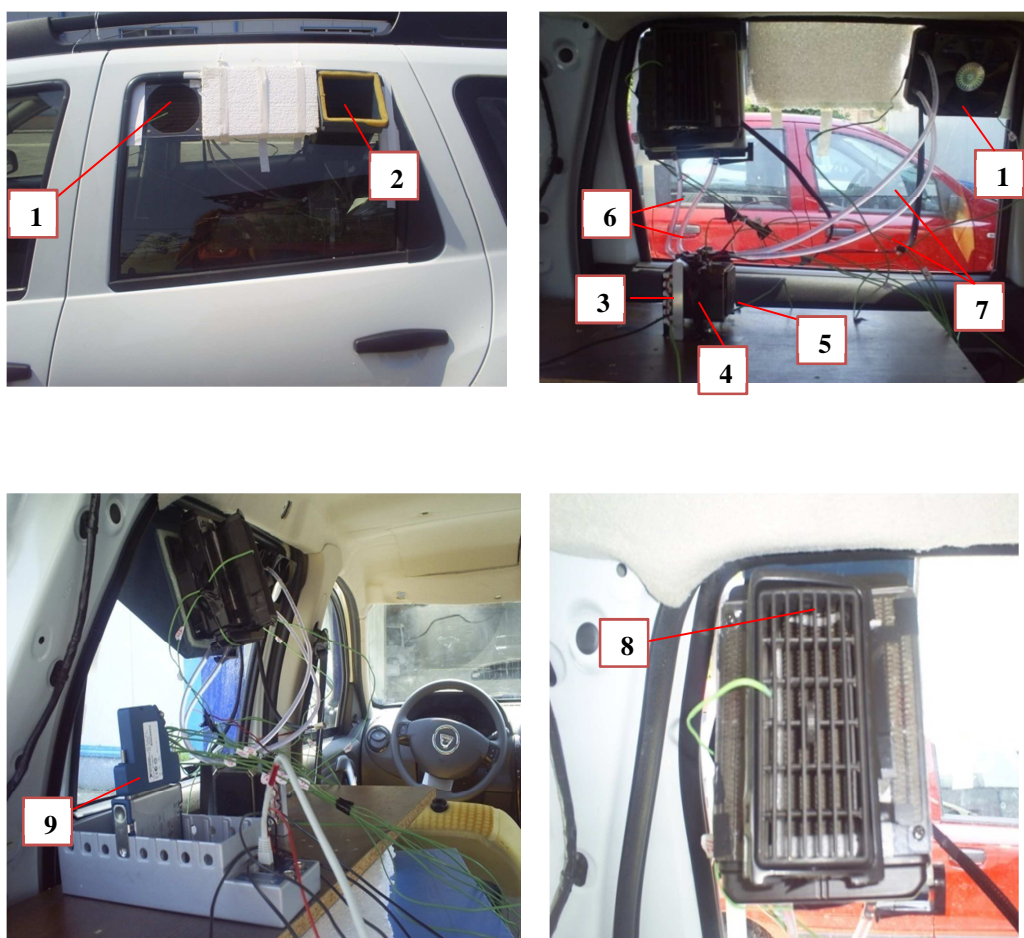
Fig. 14. Modelul funcțional al sistemului de condiționare a aerului și amplasarea termocuplelor în diferite puncte
