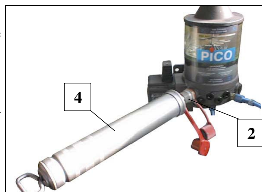
Fig. 37 Presa de umplere
