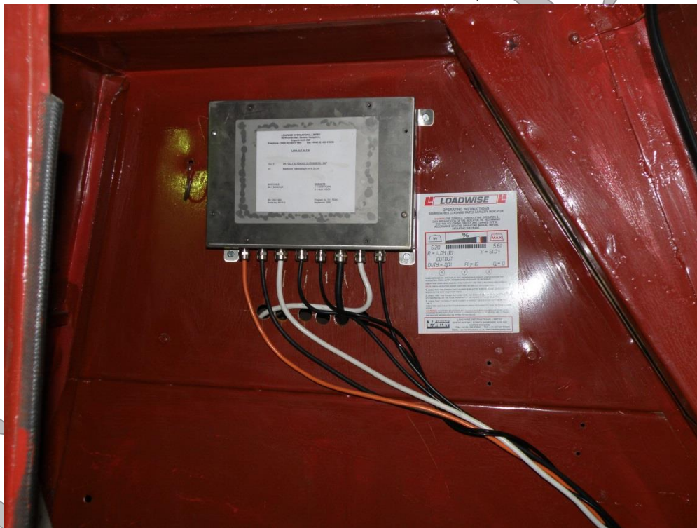
Limitator de moment – partea electrică
