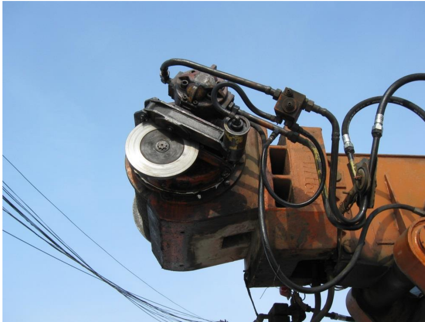
Frână cu saboți exteriori cu acționare hidraulică
