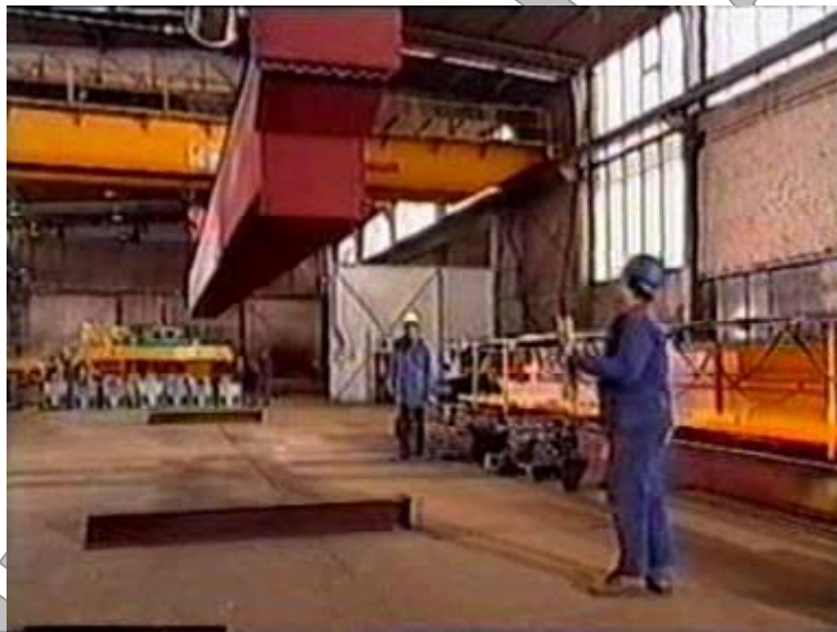
Ridicarea unei sarcini cu ajutorul a doua poduri rulante cu comandă de la sol
