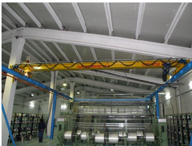
Pod rulant monogriindă cu comandă de la sol
