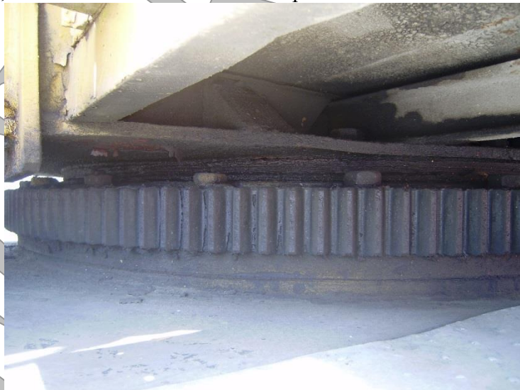
Uzură rulment platformă rotitoare
