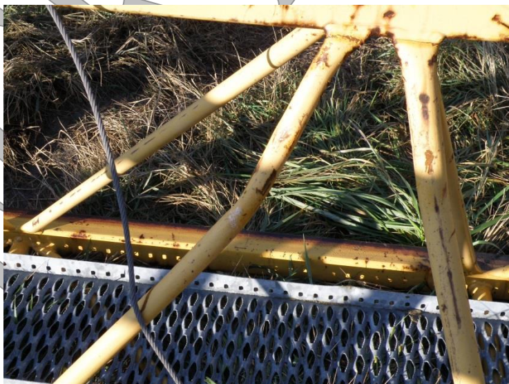
Uzură braț cu zăbrele
