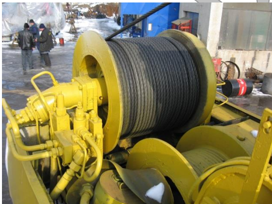
Mecanismul de ridicare–coborâre cârlig principal
