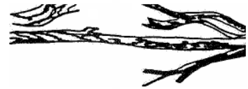
Ruperea cablului datorat deformării excesive
