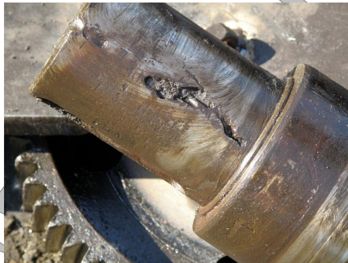
Metodă necorespunzătoare de depresare rulmenți prin tăiere cu flacăra oxiacetilenică
