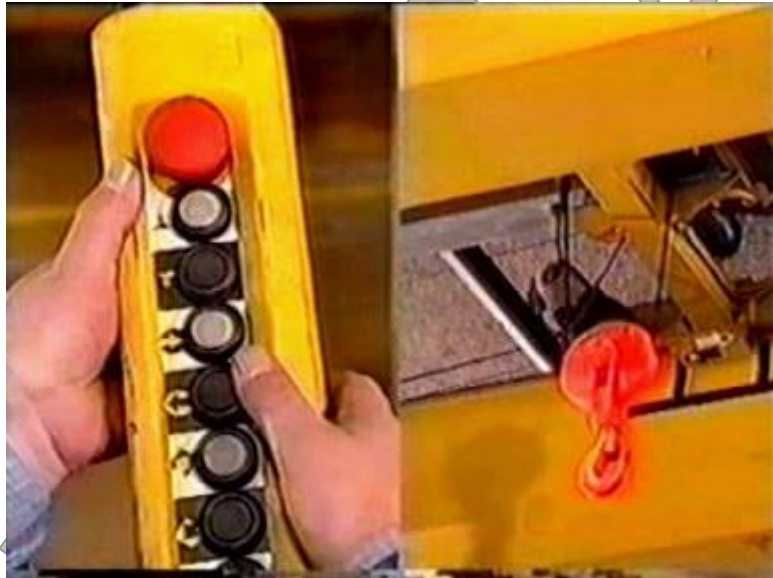
Verificarea funcționării limitatorului de sfârșit de cursă la ridicare cârlig
